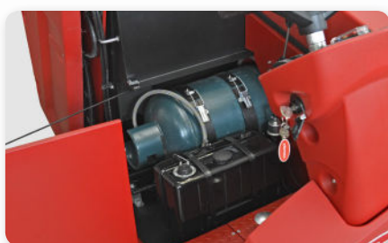
Impianto GPL LPG system Instalación de GLP
